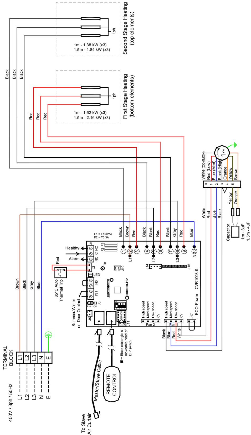
APPENDIX 2A — WIRING DIAGRAM C2-1000E and C2-1500E
