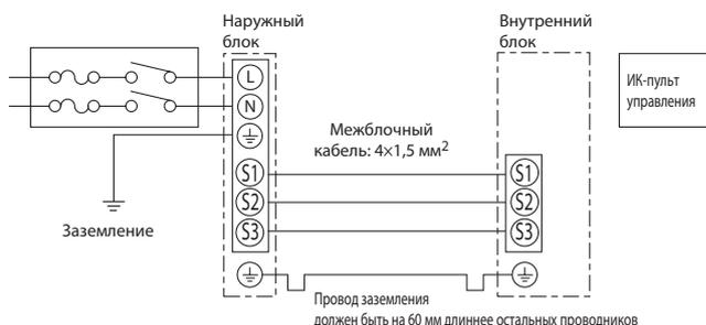
Провод заземления должен быть на 60 мм длиннее остальных проводников
