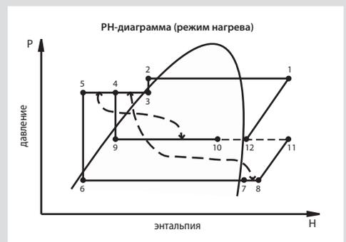
Часть жидкого хладагента, ответвленная от основного потока в цепь инъекции, превращается в парожидкостную смесь среднего давления. При этом температура смеси понижается, и она подается через специальный штуцер инъекции в компрессор, осуществляя полное промежуточное охлаждение хладагента в процессе сжатия и обеспечивая тем самым расчетную долговечность компрессора.
