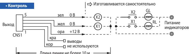
X1 - состояние: включен/выключен
