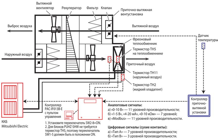
В режиме внешнего управления контроллер приточно-вытяжной установки измеряет температуру воздуха в помещении, в канале приточного воздуха или в канале вытяжного воздуха и вычисляет требуемую производительность компрессорно-конденсаторного блока (ККБ).
