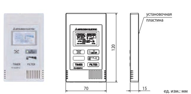
Проводной пульт для автономного управления одной или группой (не более 15) установок Lossnay.
