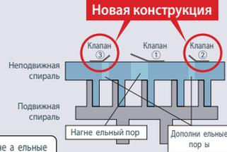
Во время работы при неполной нагрузке дополнительные нагнетательные клапаны на входе, что исключает избыточное сжатие хладагента.
