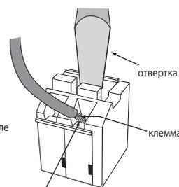
не подключайте более 1 провода в каждую клемму самозажимных клеммных колодок TB571 и TB530
