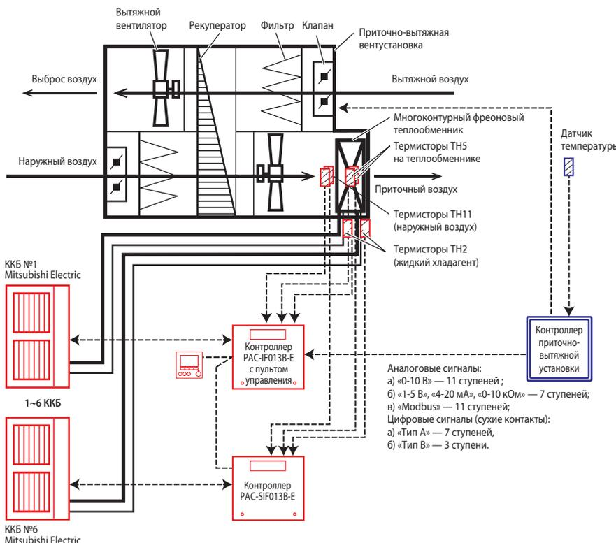
До 6 наружных блоков могут быть объединены в каскад для увеличения производительности. К каждому блоку потребуется подключить собственный контроллер PAC-SIF013B-E и объединить контроллеры сигнальной линией. Таким образом, можно сформировать систему из главного контроллера PAC-IF013B-E и 5 ведомых контроллеров PAC-SIF013B-E. Ведомые контроллеры поставляются без пультов, так как каскадом управляет один пульт, поставляемый в комплекте с главным контроллером.
