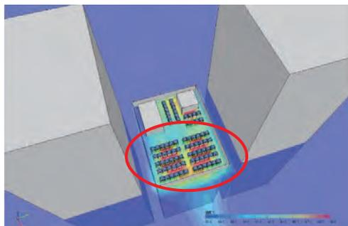
При групповой установке наружных блоков на кровле препятствия, такие как шумоотражающие экраны, ограждающие конструкции или близлежащие здания, могут создавать застойные зоны горячего воздуха.
