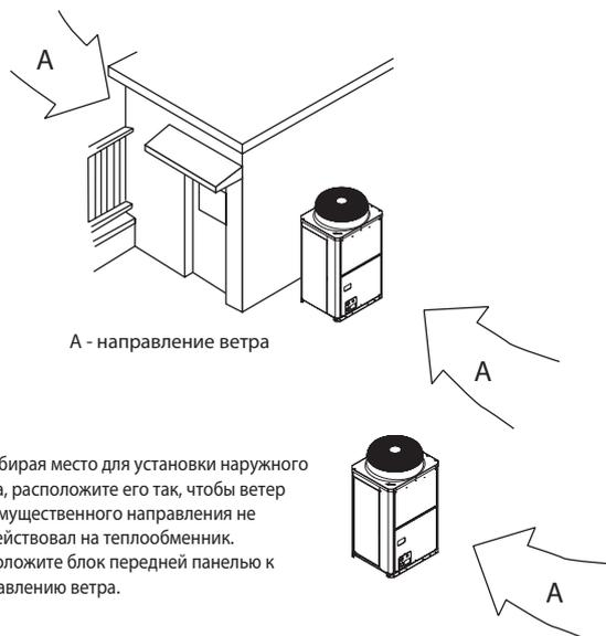
б) Выбирая место для установки наружного блока, расположите его так, чтобы ветер преимущественного направления не воздействовал на теплообменник. Расположите блок передней панелью к направлению ветра.
