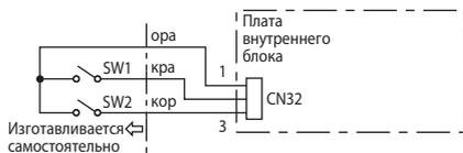
SW1: включить/выключить (действует только при замкнутом SW2)
