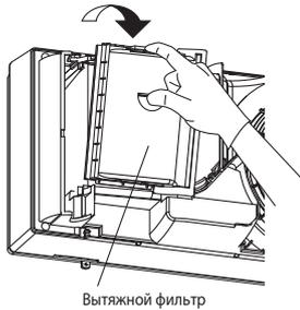
Фильтр вытяжного воздуха можно почистить пылесосом и протереть влажной тканью.
