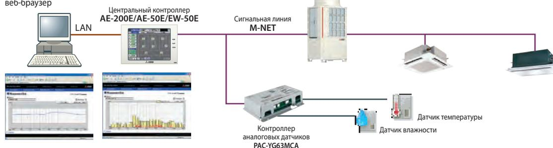
Прибор PAC-YG66DCA\* предназначен для подключения внешних цепей: 2 статических входных сигнала (сухие контакты) и 2 статических или импульсных выходных сигнала. Опционально может быть добавлено еще 4 внешних канала.
