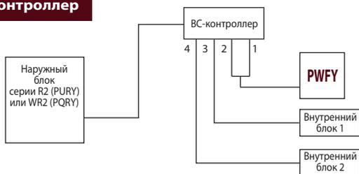
Существуют модификации BC-контроллеров с разным количеством портов (штуцеров для подключения внутренних блоков). Выбор модификации осуществляется исходя из количества помещений, в которых нужно обеспечивать охлаждение и обогрев независимо. Также следует принимать во внимание суммарную производительность внутренних блоков.
