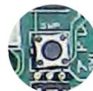
Нажмите эту кнопку для автоматического сбора хладагента в наружный блок. Система самостоятельно управляет открытием и закрытием клапанов.
