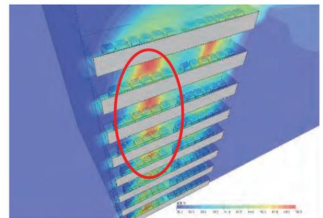
Зона высокой температуры образуется за счет конвекции воздуха, нагретого наружными блоками, установленными на нижних этажах.
