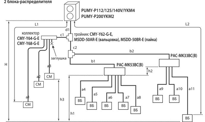
B5 — внутренние блоки бытовой серии (M-серия) и полупромышленной серии (Mr.SLIM)
