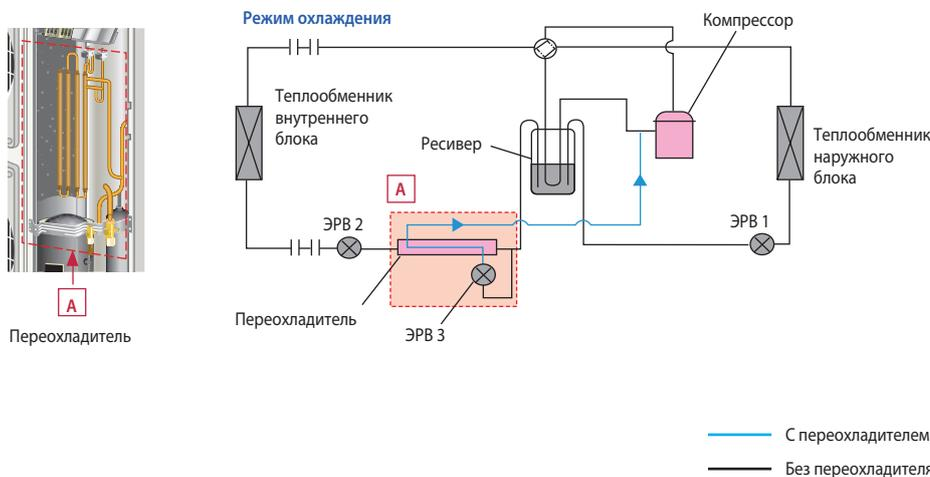
Переохладитель добавлен в гидравлический контур для увеличения энергоэффективности системы в режиме охлаждения при снижении тепловой нагрузки. Часть жидкого хладагента с линии нагнетания с помощью ЭРВ 3 перепускается в полость низкого давления переохладителя, где испаряется и поступает на всасывание компрессора, увеличивая давление всасывания. Вследствие этого нагрузка компрессора уменьшается, а энергоэффективность системы увеличивается.
