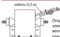
Опциональный (внешний) электронный расширительный вентиль (ЭРВ) в корпусе предназначен для уменьшения уровня шума внутренних
