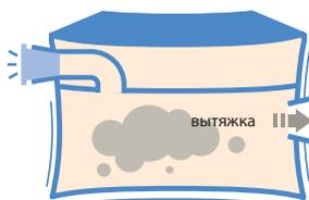
Если в помещении не организован приток свежего воздуха, то давление в помещении понижается. В этом случае эффективность установленной вытяжной системы резко падает.
