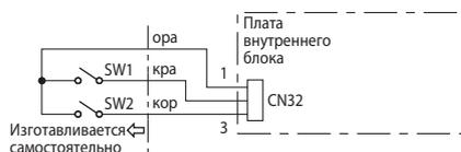
SW1: включить/выключить (действует только при замкнутом SW2)
