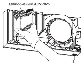
Для чистки теплообменника «LOSSNAY» следует использовать пылесос. Не допускается мочить теплообменник водой!
