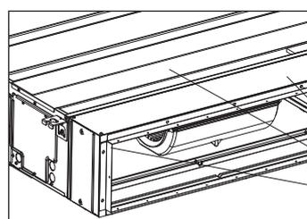
Корпус для фильтра PAC-KE91~95 TB-E позволяет подключить воздуховод к входу внутреннего блока и извлекать фильтр для обслуживания снизу или сбоку
