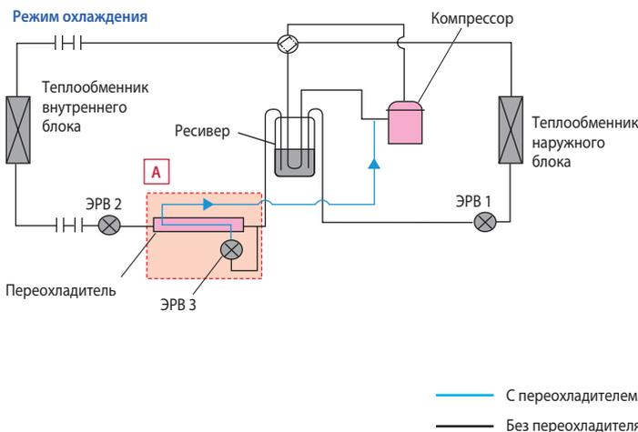
Переохладитель добавлен в гидравлический контур для увеличения энергоэффективности системы в режиме охлаждения при снижении тепловой нагрузки. Часть жидкого хладагента с линии нагнетания с помощью ЭРВ 3 перепускается в полость низкого давления переохладителя, где испаряется и поступает на всасывание компрессора, увеличивая давление всасывания. Вследствие этого нагрузка компрессора уменьшается, а энергоэффективность системы увеличивается.
