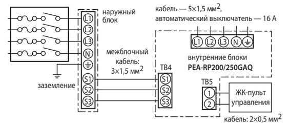
POWER Inverter 2 x PUHZ-ZRP200/250YKA, STANDARD Inverter 2 x PUHZ-P200/250YKA: кабель — 2×(5×4,0 мм<sup>2</sup>), автоматический выключатель — 2×32 А.
