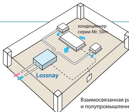
Взаимосвязанная работа вентустановки Lossnay и полупромышленного кондиционера
