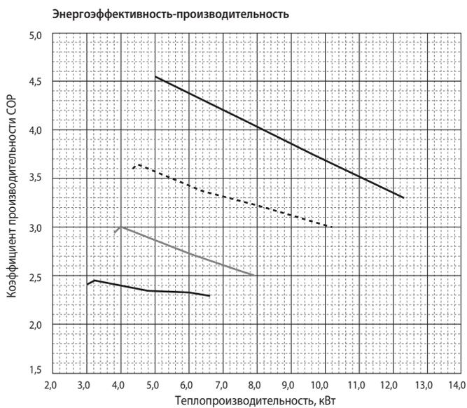
■ Температура воды на выходе +55°C
