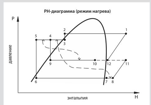
Часть жидкого хладагента, ответвленная от основного потока в цепь инjection, превращается в парожидкостную смесь среднего давления. При этом температура смеси понижается, и она подается через специальный штуцер инjection в компрессор, осуществляя полное промежуточное охлаждение хладагента в процессе сжатия и обеспечивая тем самым расчетную долговечность компрессора.
