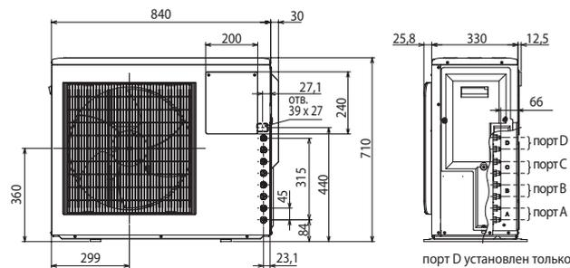
порт D установлен только в модели MXZ-4E72VA
