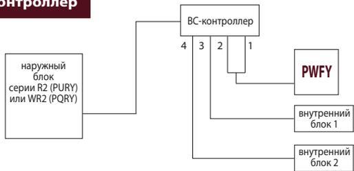
Существуют модификации BC-контроллеров с разным количеством портов (штуцеров для подключения внутренних блоков). Выбор модификации осуществляется, исходя из количества помещений, в которых нужно обеспечивать охлаждение и обогрев независимо. Также следует принимать во внимание суммарную производительность внутренних блоков.
