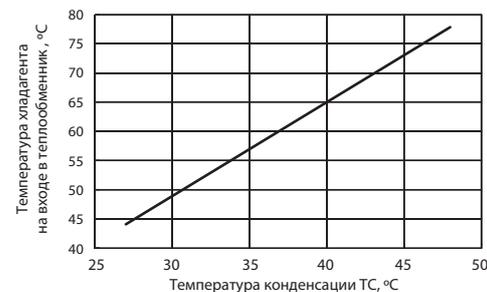
Рис. 2. Температура хладагента на входе в теплообменник
