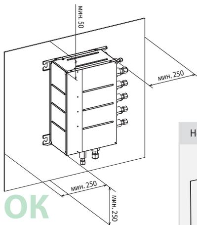
Блоки-распределители PAC-MK32BC(B) и PAC-MK52BC(B) не требуют удаления конденсата и не имеют дренажного поддона. Их можно устанавливать вертикально (крепление к стене). При этом штуцеры для подключения фреонопроводов от наружного блока должны быть направлены вниз. Другие варианты вертикального расположения блоков-распределителей недопустимы.
