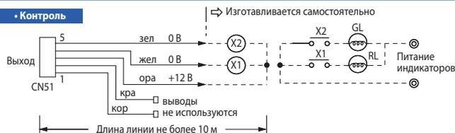
X1 - состояние: включен/выключен
