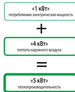
Коэффициент энергоэффективности теплового насоса:
