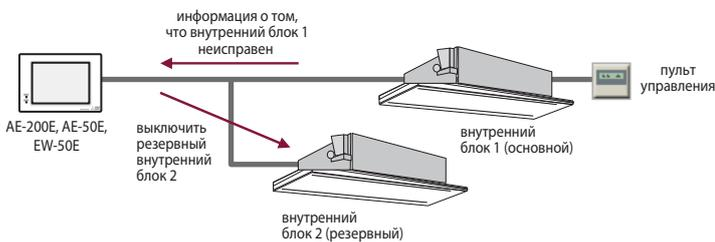
Анализ изменения состояния групп внутренних блоков, приточно-вытяжных вентустановок Lossnay и входных цепей осуществляется каждые 3~5 с. Если изменение состояния соответствует условию, предварительно запрограммированному в центральном контроллере AE-200E/AE-50E/EW-50E (от 1 до 150 условных конструкций), то активируются определенные выходные сигналы на плате управления внутреннего блока или на контроллере входных/выходных цепей PAC-YG66DCA.
