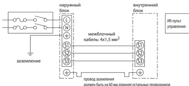
провод заземления должен быть на 60 мм длиннее остальных проводников
