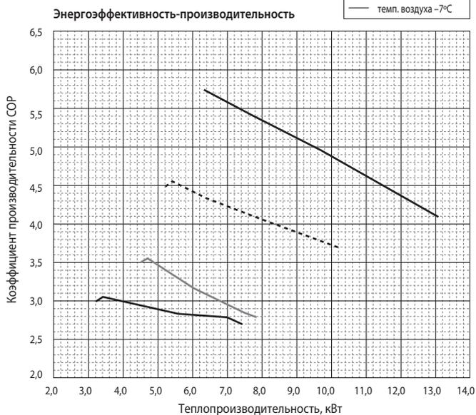
■ Температура воды на выходе +45°C
