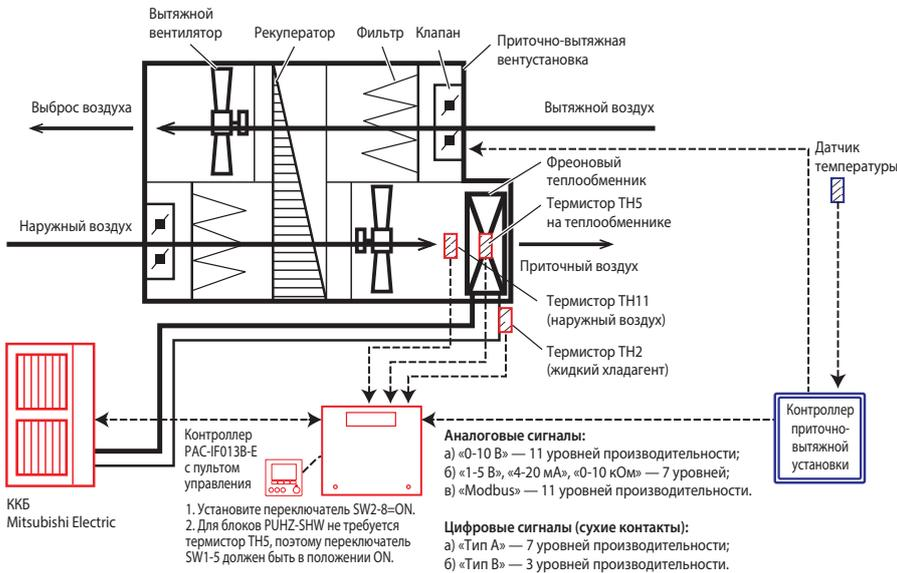
В режиме внешнего управления производительностью контроллер приточно-вытяжной установки измеряет температуру воздуха в помещении, в канале приточного воздуха или в канале вытяжного воздуха и вычисляет требуемую производительность компрессорно-конденсаторного блока (ККБ).
