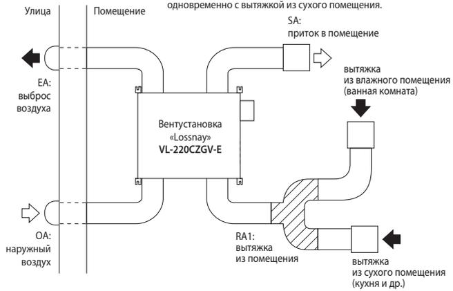
■ Схема с режимом охлаждения наружным воздухом («Free Cooling»)
