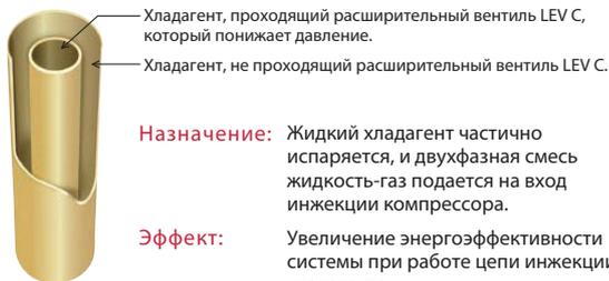
**Назначение:** Жидкий хладагент частично испаряется, и двухфазная смесь жидкость-газ подается на вход инjection компрессора.
