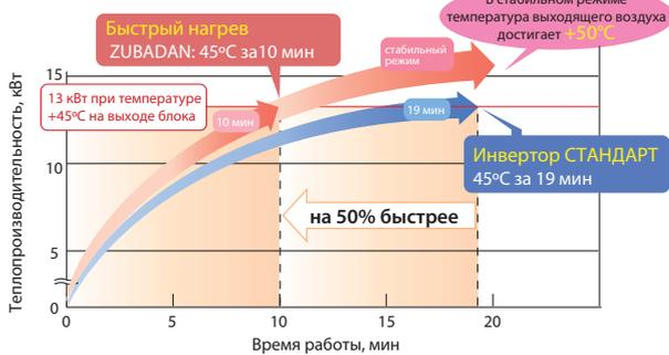
Температура наружного воздуха  $-20^{\circ}\text{C}$
