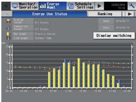
Электроэнергия, потребленная системой кондиционирования воздуха, а также время работы вентилятора внутреннего блока отображаются в виде столбчатой диаграммы с детализацией по месяцам, дням или часам.
