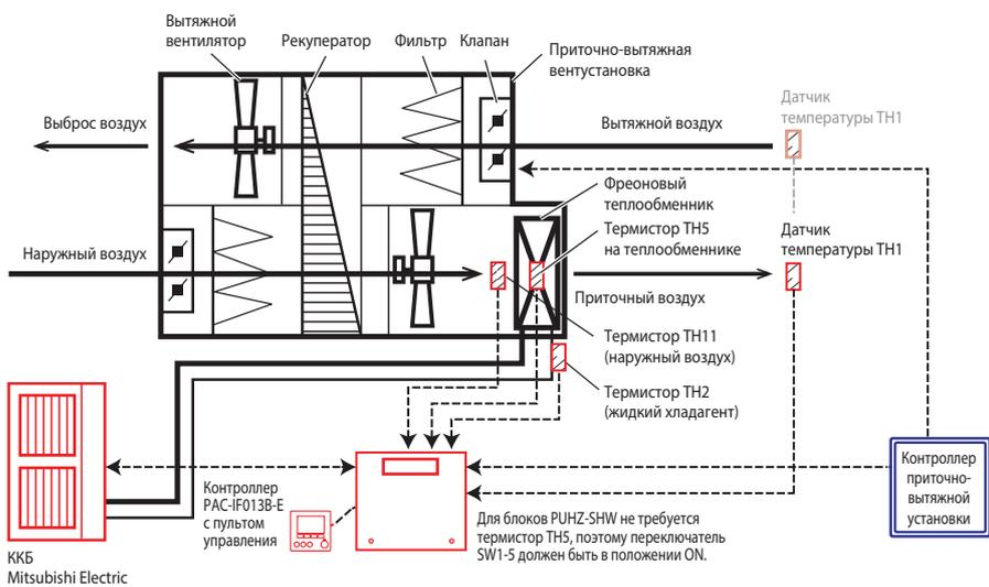
В режиме автономного управления температурой контроллер PAC-IF013B-E самостоятельно измеряет температуру воздуха и регулирует производительность. В этом варианте пользователь управляет охлаждением или нагревом с помощью пульта, который поставляется в комплекте с контроллером PAC-IF013B-E. Контроллер способен поддерживать температуру воздуха:
