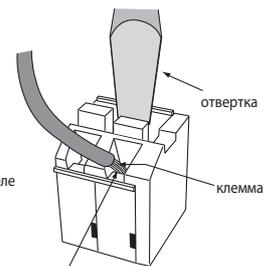
не подключайте более 1 провода в каждую клемму самозажимных клеммных колодок TB571 и TB530
