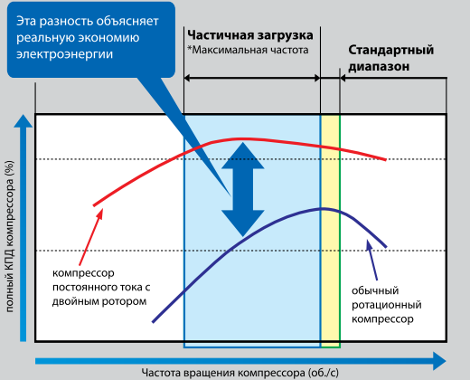
Сравнение компрессора постоянного тока с двойным ротором и обычного ротационного компрессора
