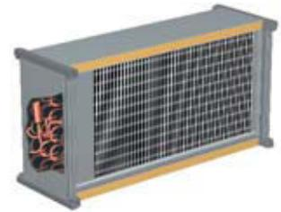
Теплообменники биметаллические из Cu/Al, Cu/Cu и Cu-Sn/Cu-Sn (трубки/оробрение). Корпус изготовлен из оцинкованной или нержавеющей стали. Воздухоохладители укомплектованы наклонными поддонами из нержавеющей стали и оцинкованными или пластиковыми каплеуловителями.
