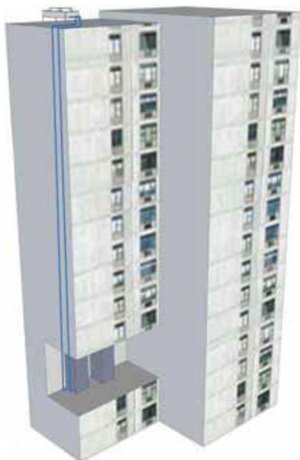
Пример размещения кондиционера и сухого охладителя
