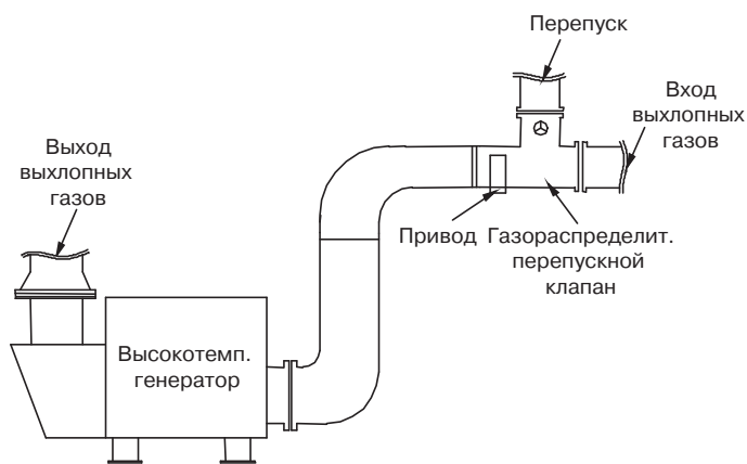
Пример установки газораспределительного перепускного клапана
