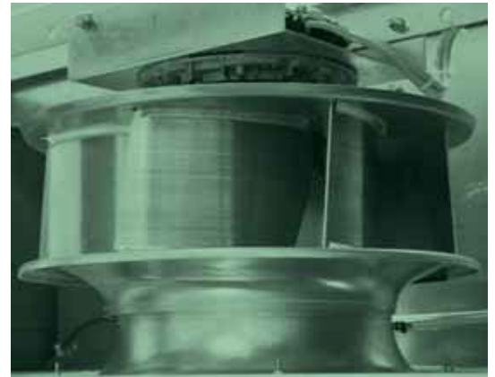
ЕС-вентилятор с плавным электронным регулированием частоты вращения
