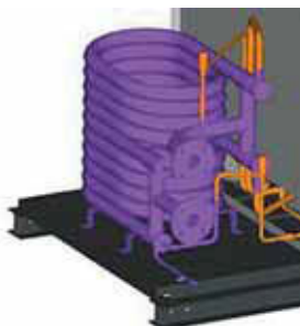
Водяной теплообменник типа «труба в трубе»
