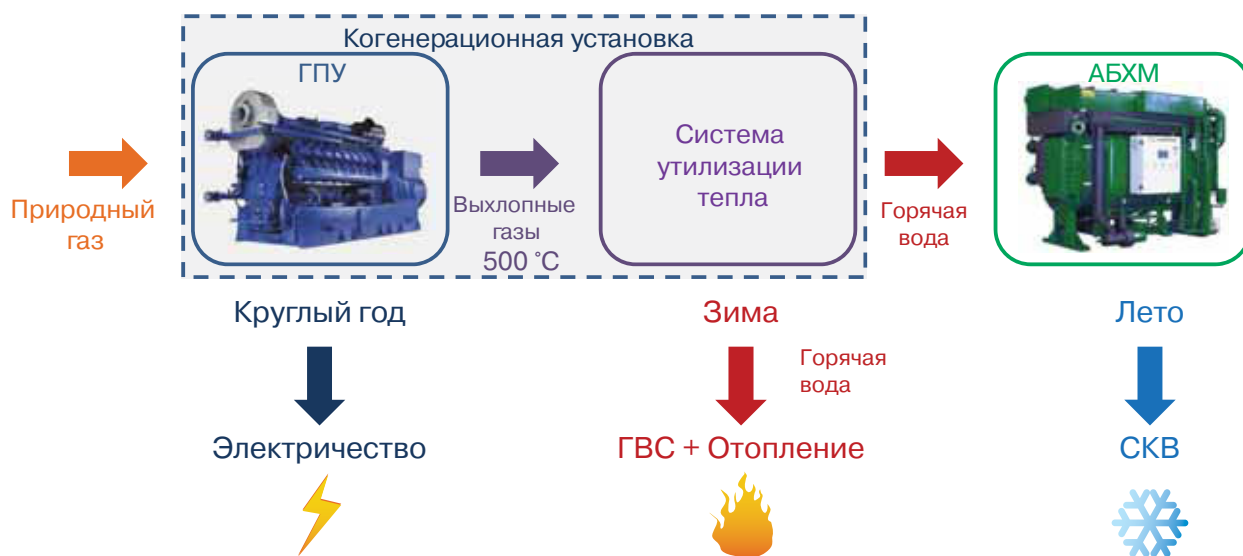
Рис. 2. Вариант применения АБХМ в системах тригенерации
