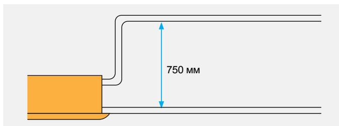
Дренажный насос с высотой подъема конденсата до 750 мм входит в комплект поставки кассетного блока Carrier. Повышенный напор насоса облегчает выбор места для установки блока.
