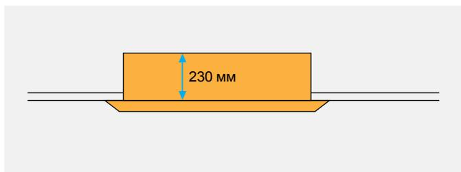
Высота кассетного 4-поточного блока составляет от 230 до 300 мм, в зависимости от типоразмера. Такая небольшая высота позволяет установить блок при небольшом зазоре за подвесным потолком.
