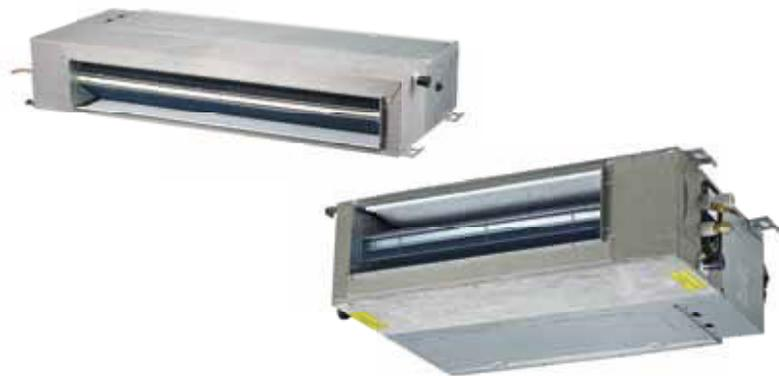
Канальные блоки производительностью от 2,2 до 7,1 кВт можно установить за подвесным потолком или под потолком. Они незаметны в помещении и отличаются низким уровнем шума. Внешнее статическое давление 10-30 Па.
