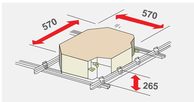
Размеры компактного кассетного блока всего 570x570 мм, что позволяет установить его в стандартную ячейку подвесного потолка. Блок такой легкий и компактный, что для его монтажа не требуется подъемник.
