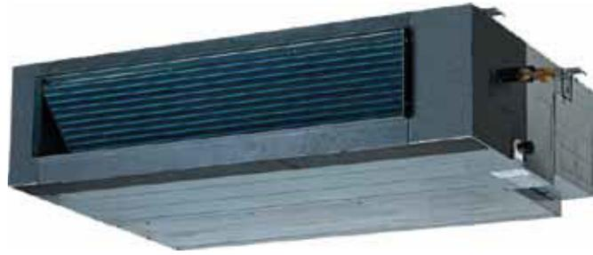
Мощные каналные блоки производительностью от 8 до 14 кВт можно установить за подвесным потолком или в углублении потолка. Они незаметны в помещении и отличаются низким уровнем шума. Внешнее статическое давление до 100 Па.
