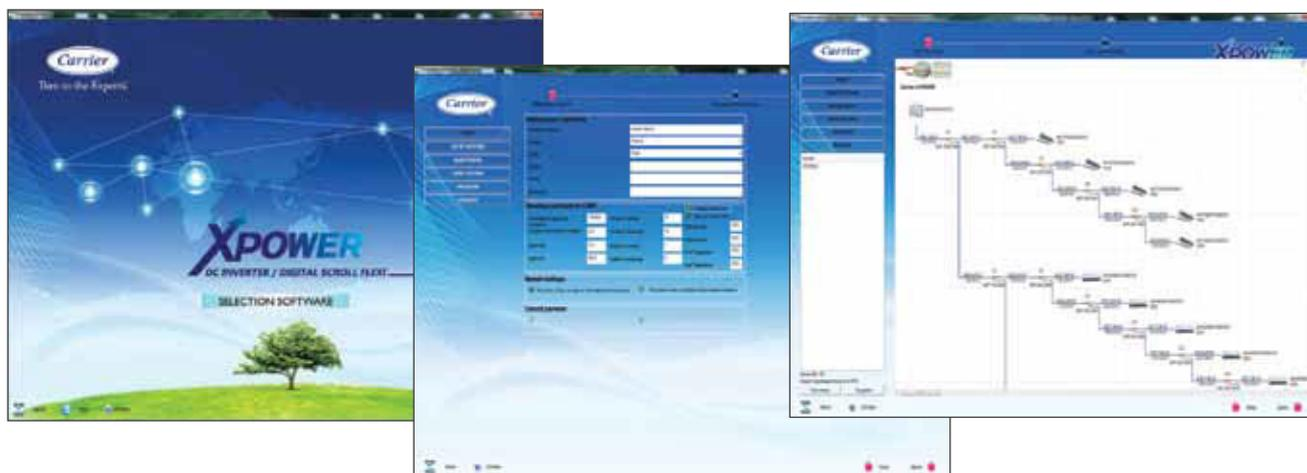
Программа подбора учитывает требуемые холодо- и теплопроизводительности блоков, расчетные температуры, перепады высот между блоками и длины участков трубопровода. К полученной системе можно добавить индивидуальные пульта или центральный пульт управления.
