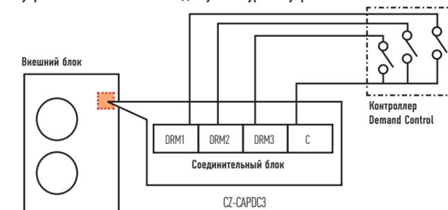
\* Установка "Regular Demand Control" доступна только для внешнего блока ECOi серии 6N. (Система будет ограничена только максимальным входным уровнем мощности без приема входного сигнала). (Эта установка выбирается при первоначальном запуске системы или ее техническом обслуживании с помощью сервисного пульта ДУ).
