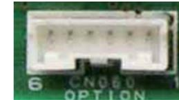
PAW-OCT: Panasonic разработал дополнительное оборудование, поставляемое по желанию заказчика, (состоящее из штекера и проводов) под названием PAW-OCT для простого подключения к разъёму (CN060).
