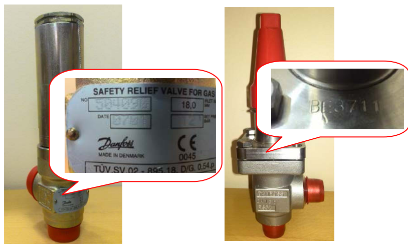
Рис.7 Пример определения даты SFV и SVA
