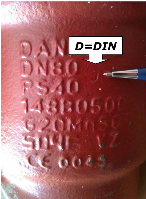
Рис.3 Пример определения SVA
