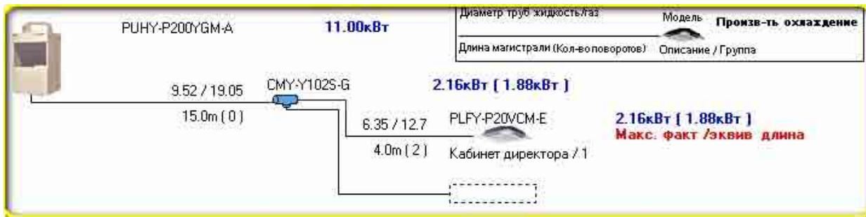
Аналогичным образом подключаем на свободный участок магистрали следующий разветвитель, затем внутренний блок и так далее.
