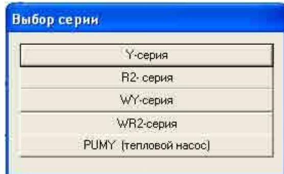
**Y-серия** – VRF система кондиционирования Сити Мульти с воздушным охлаждением конденсатора, внутренние блоки которой могут работать в режиме охлаждения или обогрева.
