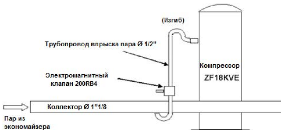
Рис. 14: Пример трубной обвязки для впрыска пара в установку из пяти компрессоров ZF18KVE
