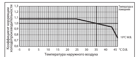
Рис. 2. Коррекция производительности наружного блока по температуре
