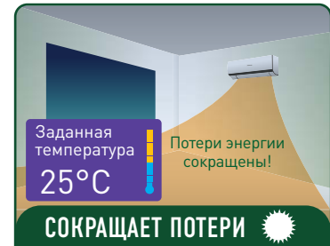
Заданная температура не меняется. ECONAVI сокращает мощность обогрева на значение, эквивалентное уменьшению заданной температуры на 1°C.
